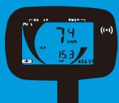
Display multifunción que permite seleccionar 3 marchas diferentes y con indicador de velocidad, kilometraje, capacidad de batería, etc.
