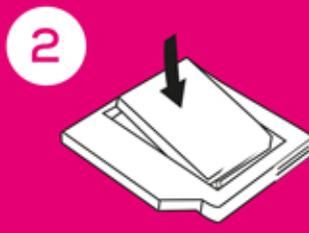
3 Coloque la banda y fije el disco duro en el soporte.
