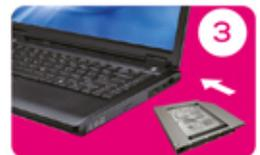
Introduce nuevamente la unidad dentro de la bahía de disco óptico de su portátil. Fijela siguiendo las instrucciones del manual de su portátil.
