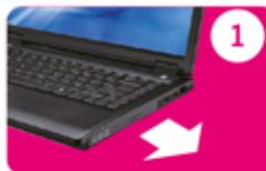
Desconecte la alimentación de su portátil y retire la unidad óptica. Consulte el manual de desmontaje de su ordenador.
